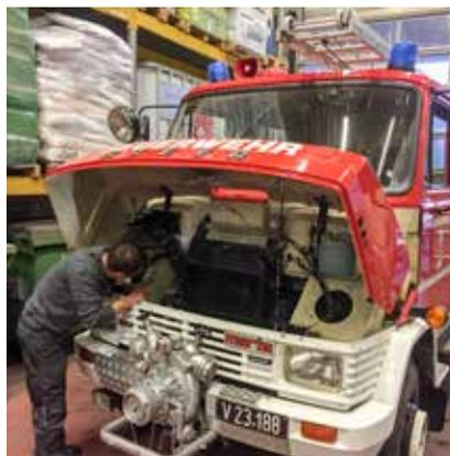
Leuchten versehen, eine Rundum- und Innenbeleuchtung installiert und die Blaulichter erneuert. Durch diese Maßnahmen kann davon ausgegangen werden, dass das SLF noch einige Jahre für die Sicherheit am Nächsten zur Verfügung steht und somit die Anschaffung eines neuen Löschfahrzeuges derzeit nicht notwendig ist. Vielen Dank den Helfern und der Firma Scheier!
